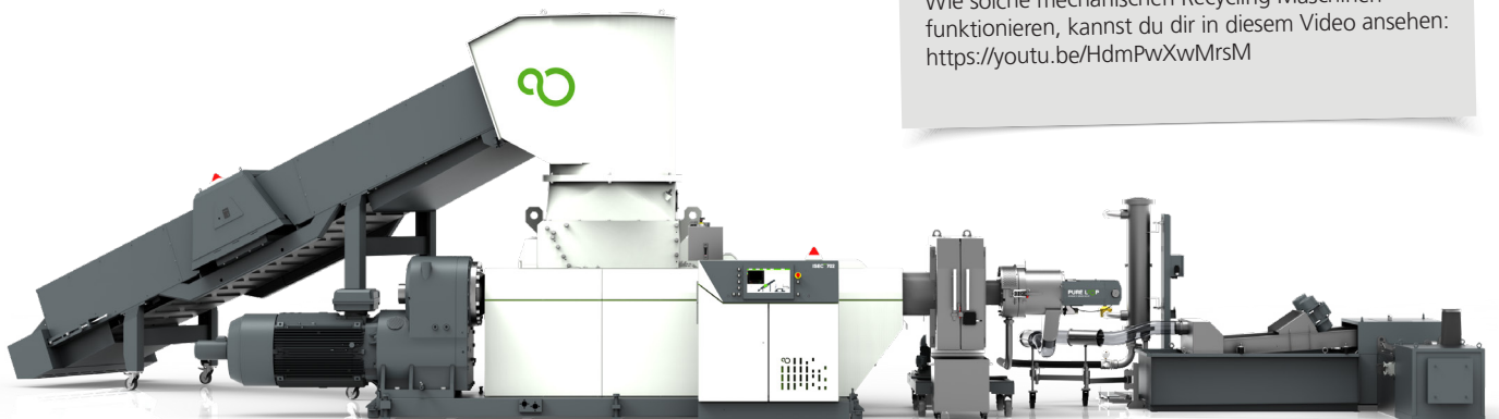
Diese Shredder-Extruder-Maschine von PURE LOOP produziert Regranulat für Kappen der STABILO Leuchtmarker.
