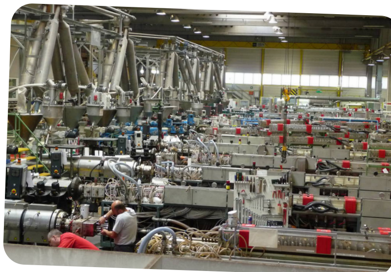
In dieser Produktionsanlage von Internorm werden Fensterprofile mittels Extrusion hergestellt.
